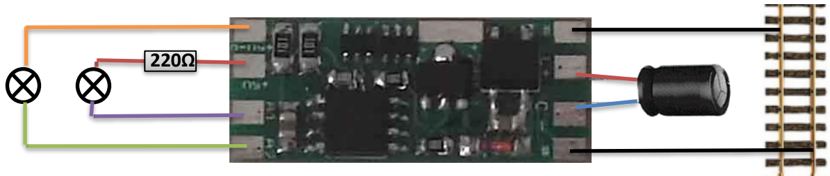
Anschluss von LEDs / LED connection
