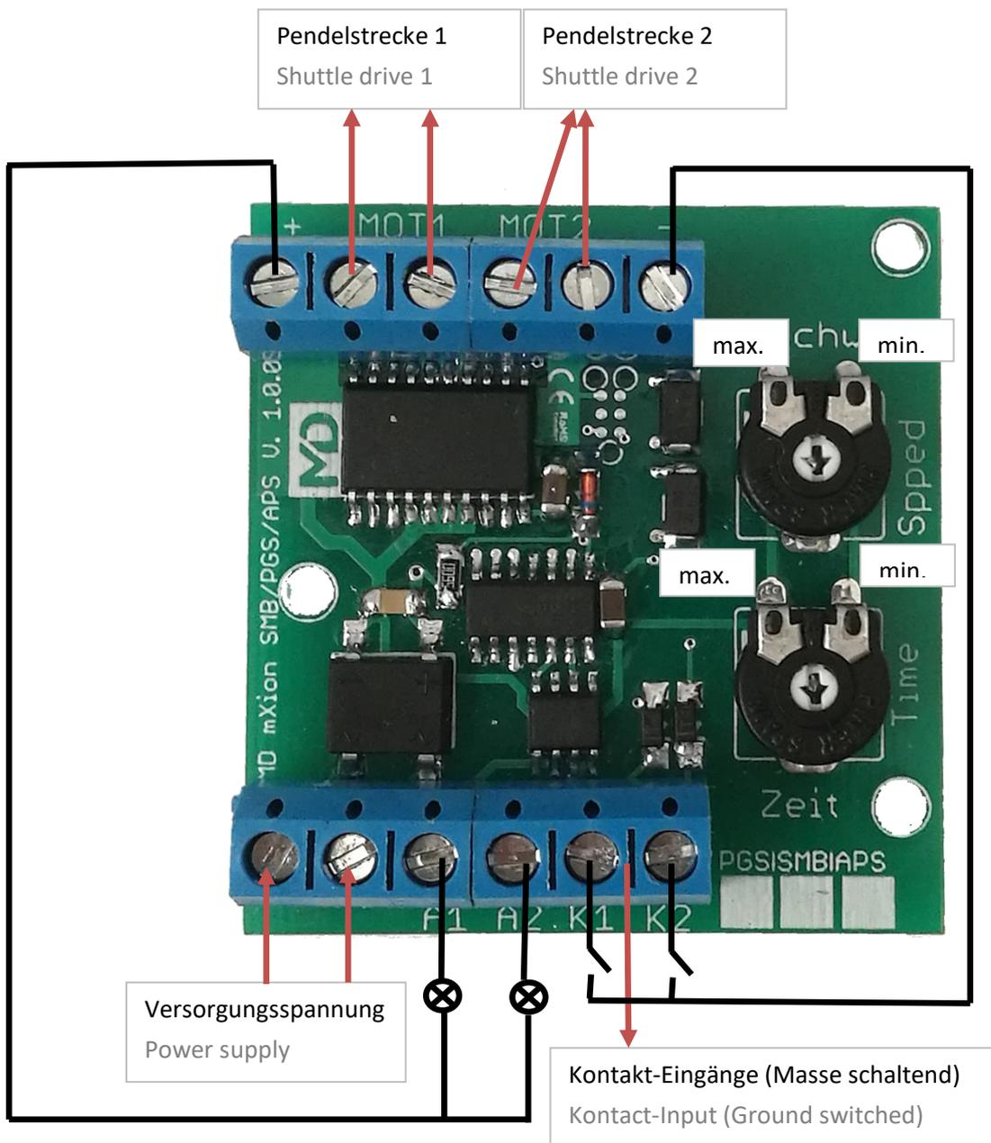
Fahrzeit über Poti oder Kontakteingänge einstellbar. Fahrgeschwindigkeit wird über den angeschlossenen Regeltrafo definiert. MOT1 und MOT2 zusammenschließen um 1 Kanal mit 2 A zu erhalten, sonst 2 Kanäle.
