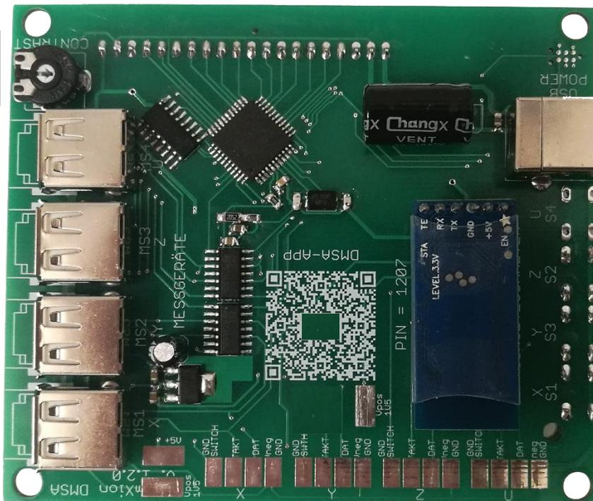
Alle Achsen (X,Y,Z,U) als Lötkontakte ausgeführt zum Anschluss von Messschiebern ohne USB-Buchse
