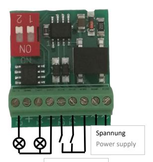
Verbinden oder Funktionsausgang eines Decoders
