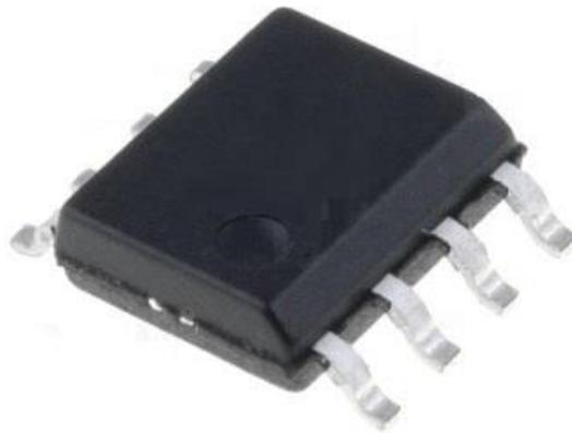
Das oben abgebildete IC kann in Schaltungen via Test-Clip kontaktiert werden. Nicht alle ICs besitzen das Loch und gleichzeitig noch die abgeschrägte Seite; mindestens eine Markierung ist allerdings immer vorhanden. Der Pin, ganz oben direkt am Loch, ist Pin 1; genauso an der abgeflachten Seite (befindet sich von oben draufgeguckt immer links) ist der Pin 1 immer ganz oben links. Auf die Seite von Pin 1 muss die beim Test-Clip markierte Ader gesetzt werden.
