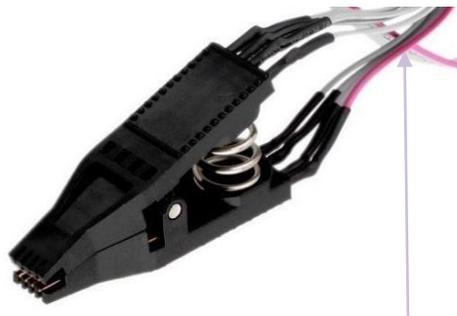
Test-Clip; Pin 1 (Beim SMD-IC oben links, linke Seite; von oben gesehen. IC besitzt dort eine Kerbung/Lochvertiefung und ggf. ist die Seite des Chips dort abgeschrägt).
