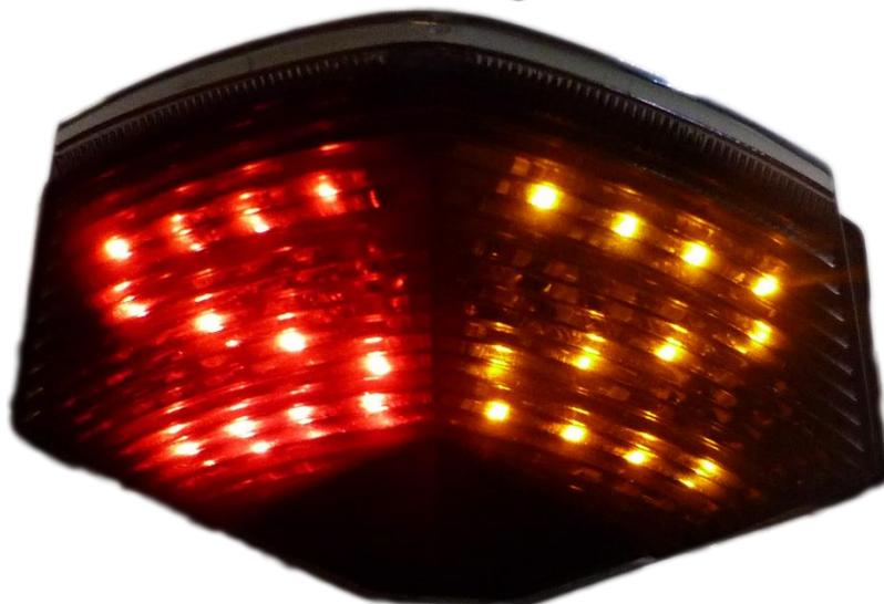
Die oben dargestellten Bilder zeigen (v. o. n. u.) Rücklicht Z-Form, Bremslicht, Blinker rechts aktiv.
